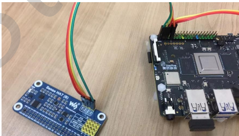
图 1-1 将 Sense Hat (B) 连接到 40-Pin GPIO Header
